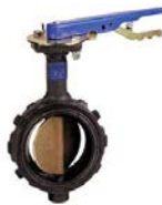
LD2000 BFV Lug Style 200 PSI, D.I. Body Molded-in Liner D.I., S.S. or Alum. BRZ Disc Size 14" - 24"
