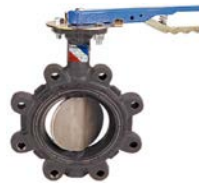
LD3000 BFV Lug Style 250 PSI, D.I. Body Molded-in Liner D.I., S.S. or Alum. Brz. Disc Size 2" - 12"
